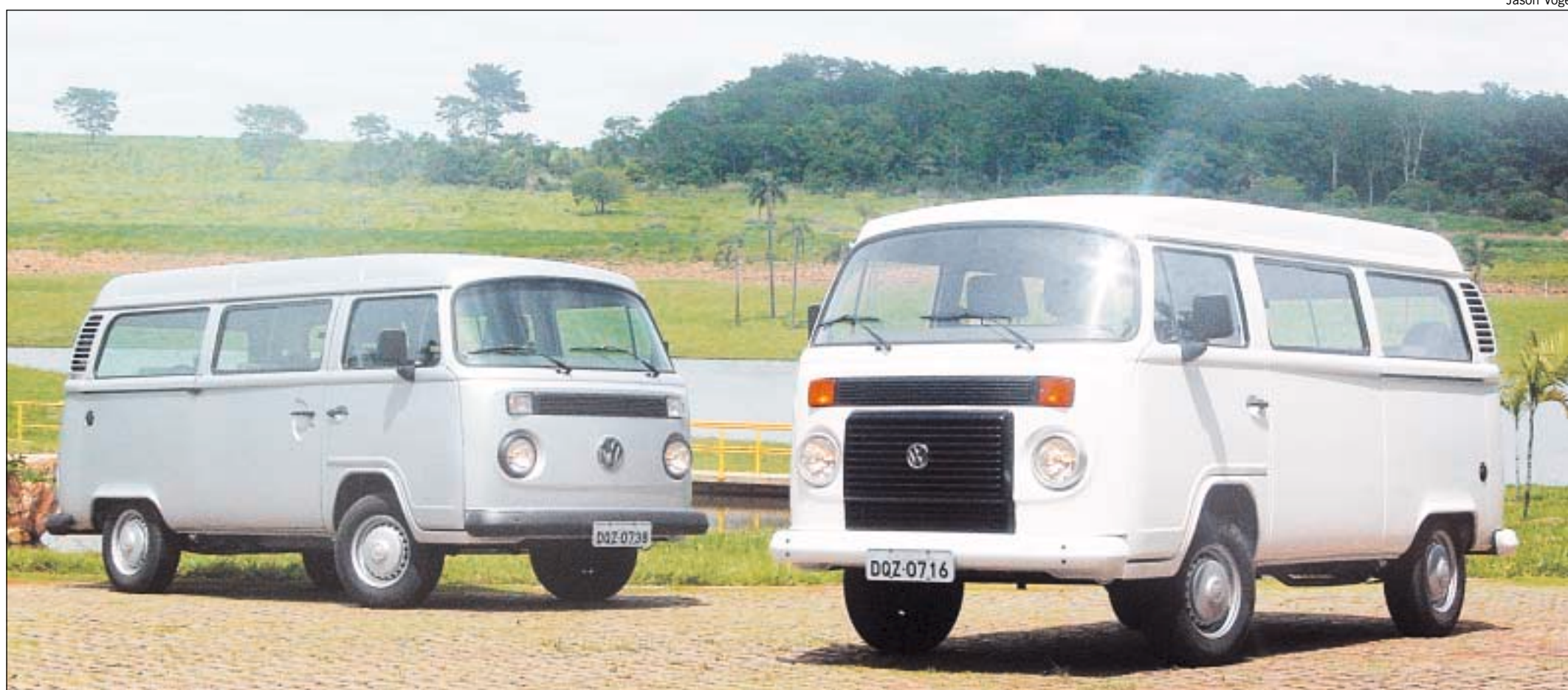
POR FORA a novidade é a grade do radiador da nova versão (à direita). Na comparação, a Série Prata, última Kombi refrigerada a ar. A carroceria da atual versão brasileira é semelhante à do modelo alemão de 1967
